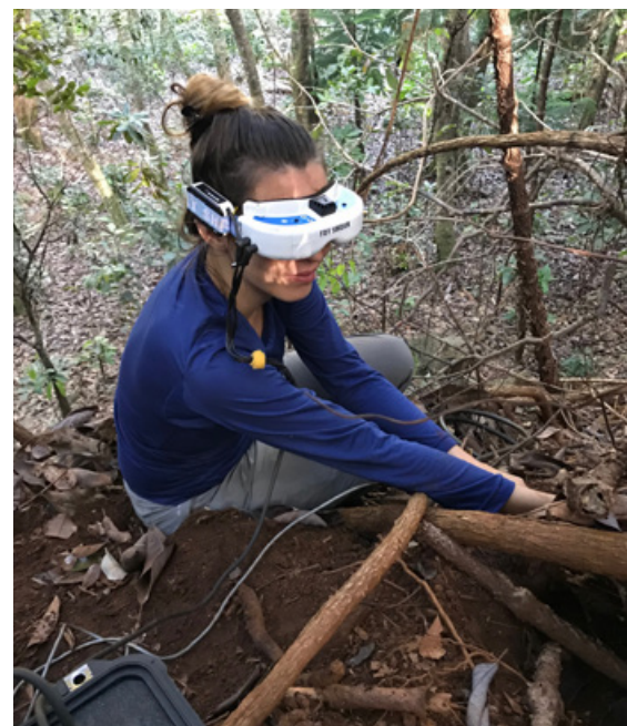
Inspection des terriers de pétrels à l'aide d'une caméra endoscopique reliée à des lunettes de réalité virtuelle (photo : IRD-UNC)
